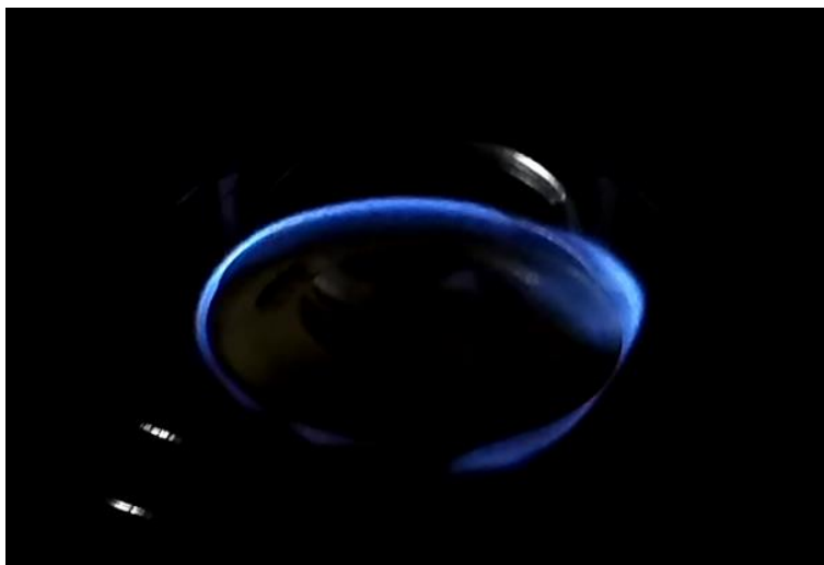
Gambar 2.4 Uji Nyala Api Biogas Sederhana
